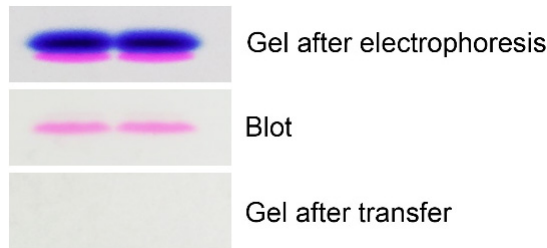
图1. 双色类SDS-PAGE蛋白上样缓冲液产品用于BeyoGel™ Plus PAGE预制胶(Tris-Gly, 12%, 10孔) (P0458S)的电泳后的凝胶图(Gel after electrophoresis)、转膜后PVDF膜图(Blot)和转膜后凝胶图(Gel after transfer)。
